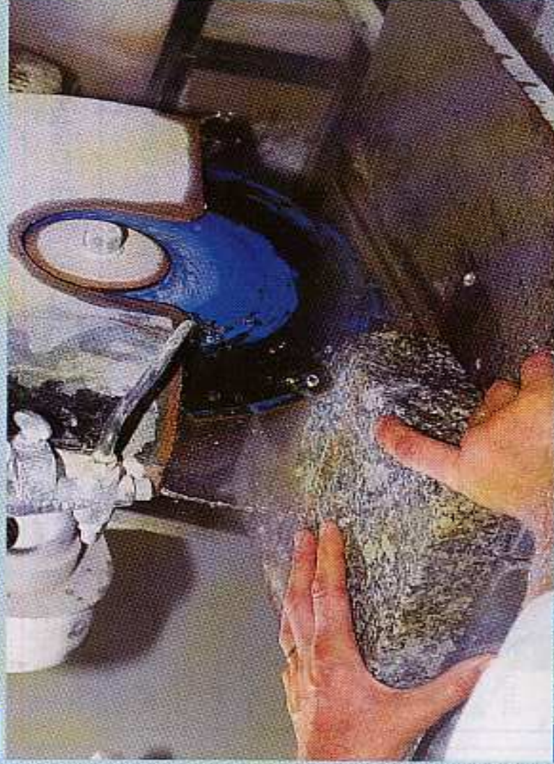
1 Découpage de la roche par sciage.
